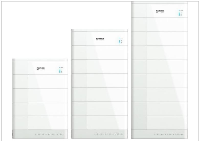
Das Hochspannungs-LiFePO<sub>4</sub>-Batteriesystem GTX 3000-H besteht aus 4 bis 10 Batteriemodulen (51,2 V / 50 Ah) und einer Batteriekontrolleinheit (BCU), die in Reihe geschaltet sind und einen Betriebsspannungsbereich von 180 V-700 V haben. Es fungiert hauptsächlich als Energiespeicher für Haushalte und Gewerbe und ist kompatibel mit einem von SofarSolar-Hochspannungs-Wechselrichter wie dem HYD 5...Serie 20KTL-3PH.
